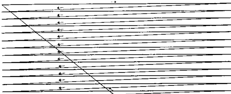
Figura 2.7. Trayectoria del haz de electrones en un barrido completo
